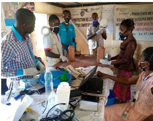
Figure 15: Production du chlore liquide à base WATA pour le lavage des mains
